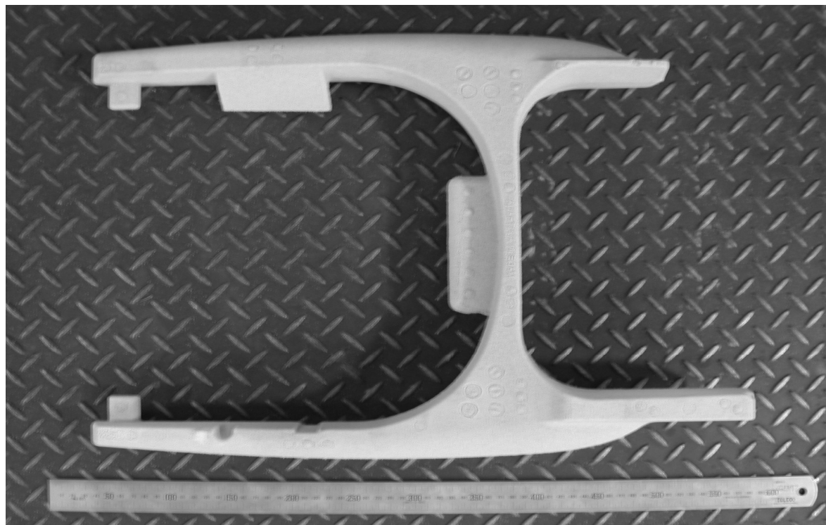
Rys. 4. Rdzeń odlewu wahacza tylnej osi motocykla. Masa rdzenia wynosi 3,8 kg.
