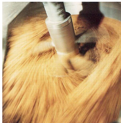
Rys.5. Przemieszczanie się cząstek masy w mieszarce turbinowej.
