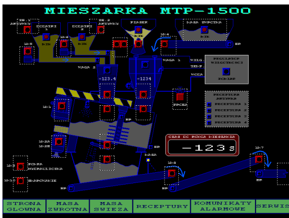
Rys.8. Ekran synoptyczny mieszarki turbinowej MTP-1500 w odlewni WSK PZL RZESZÓW.
