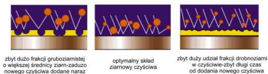
Rys.5. Wpływ granulacji śrutu na jakość obróbki strumieniowo-ściernej[9]
