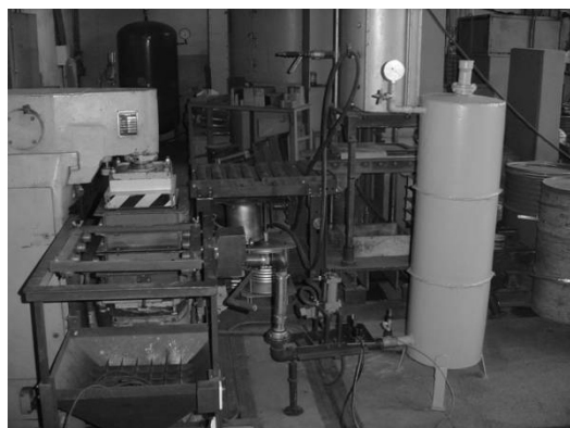
Rys. 5. Widok i schemat prototypowego stanowiska do badań procesu formowania podciśnieniowego: a) modelowe, b) prototypowe na bazie formierki FKT 54; 1- zbiornik podciśnieniowy, 2- pompa próżniowa z napędem, 3- silnik, 4 i 7- czujniki ciśnienia, 5- zawór, 6- skrzynka formierska z nadstawką, 8- otwory odpowietrzające, 9 – forma z PMM
