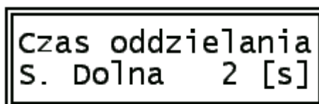
Rys. 5. Nastawa czasu oddzielania skrzynki dolnej od modelu.
