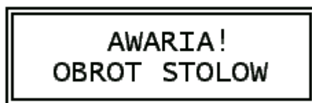
Rys. 8. Komunikat awarii mechanizmu obrotu stołów.
