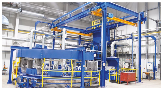
Формовочная линия - технология ВАКУУМ-ПЛЕНОЧНОЙ ФОРМОВКИ
