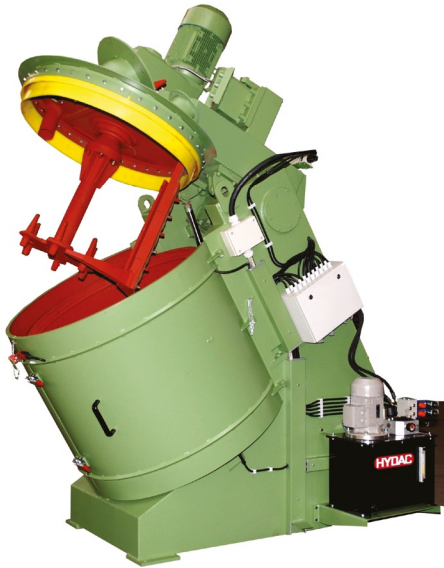
Mieszarki dynamiczne z podnoszoną pokrywą typu MDP
