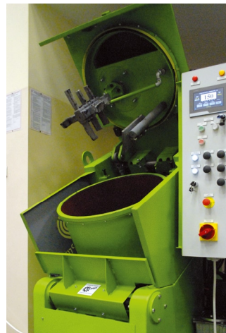
Mieszarki dynamiczne z podnoszoną pokrywą i wychylną misą typu MDM
