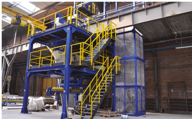
Stanowiska sporządzania materiałów ognioodpornych, mieszanek żywicznych do rdzeni
