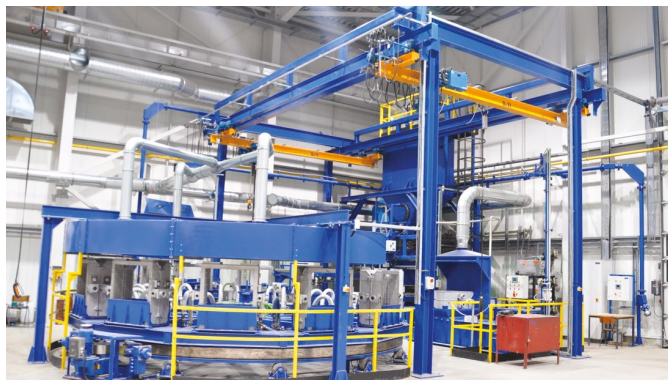
Linie formierskie skrzynkowe - technologia VACUUM PROCES
