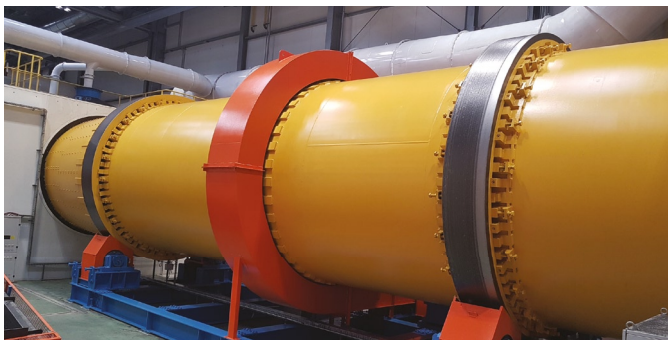
Montaż bębna wybijającego Q=300 t/h
