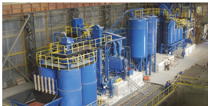
Montáž linky přípravy obalovaných písků Q=4 t/h
