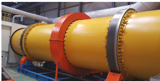
Montáž vyloukacího bubnu Q=300 t/h
