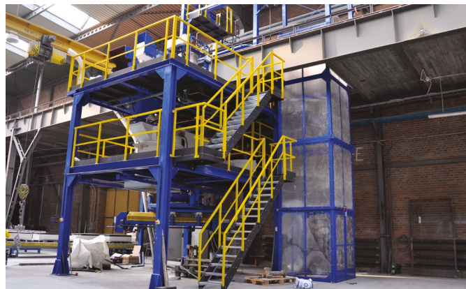
Stanoviště přípravy žárovzdorných materiálů, pryskyřičných směsí na jádra
