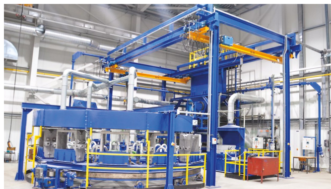
Formovací rámové linky - technologie formování VACUUM PROCES
