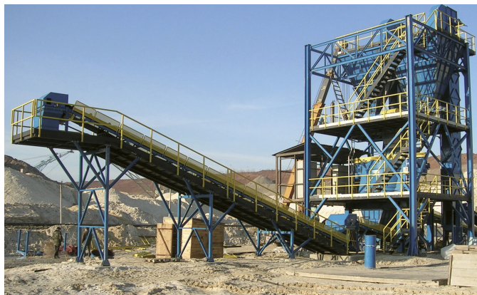
Linia technologiczna mieszania piasku kwarcowego z gliną
