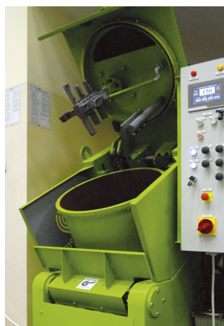
Mieszarki dynamiczne z podnoszoną pokrywą i wychylną misą typu MDM
