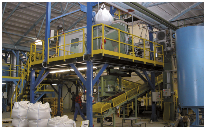
Linia technologiczna mieszania i granulowania proszków spawalniczych
