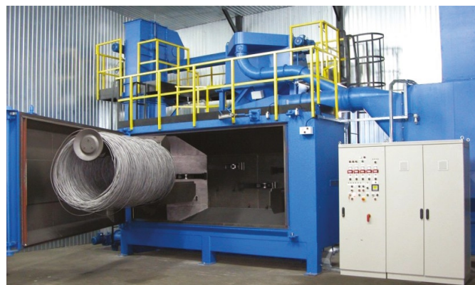
Oczyszczarka wirnikowa komorowa do czyszczenia walcówki w kręgach
