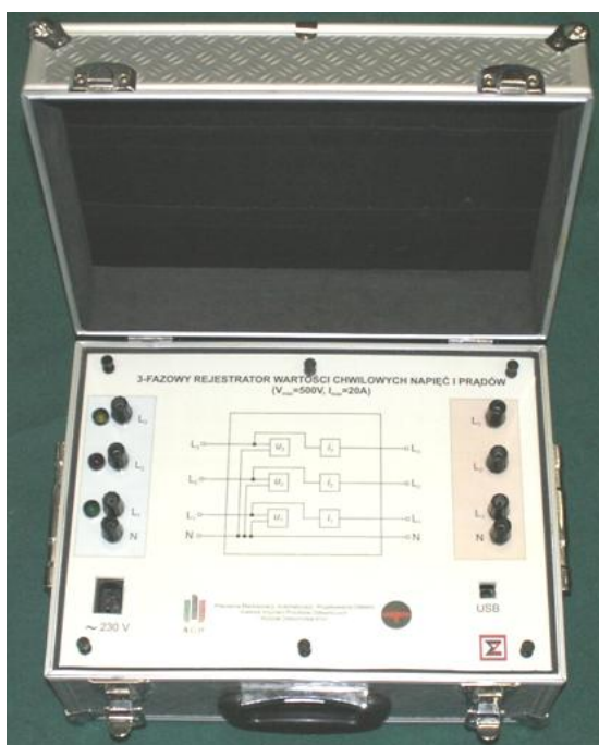
Rys. 8. Widok 3-fazowego rejestratora wartości chwilowych napięć i prądów
