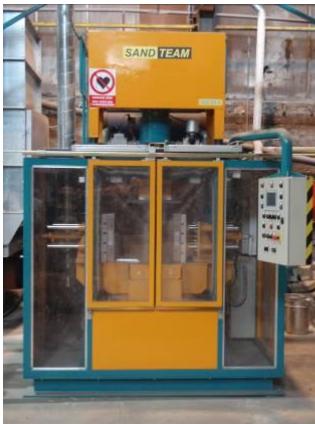
Rys 1. Strzelarka VGi 20.0 (Objętość jednego strzału wynosi 20 litrów).
