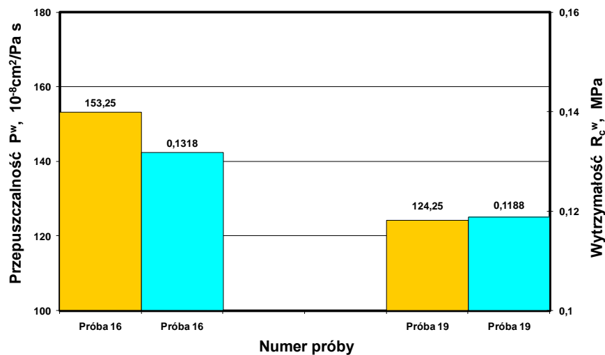
Rys.12. Wartości właściwości technologicznych masy odświeżanej w mieszarce wirnikowej MTP-500 dla różnych czasów mieszania; 16 - \tau_m = 170 s, 19 - \tau_m = 90 s
