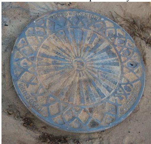
Rys 5. Przykład odlewu włazu kanalizacyjnego bezpośrednio po wybicciu z formy, przed jego oczyszczeniem
