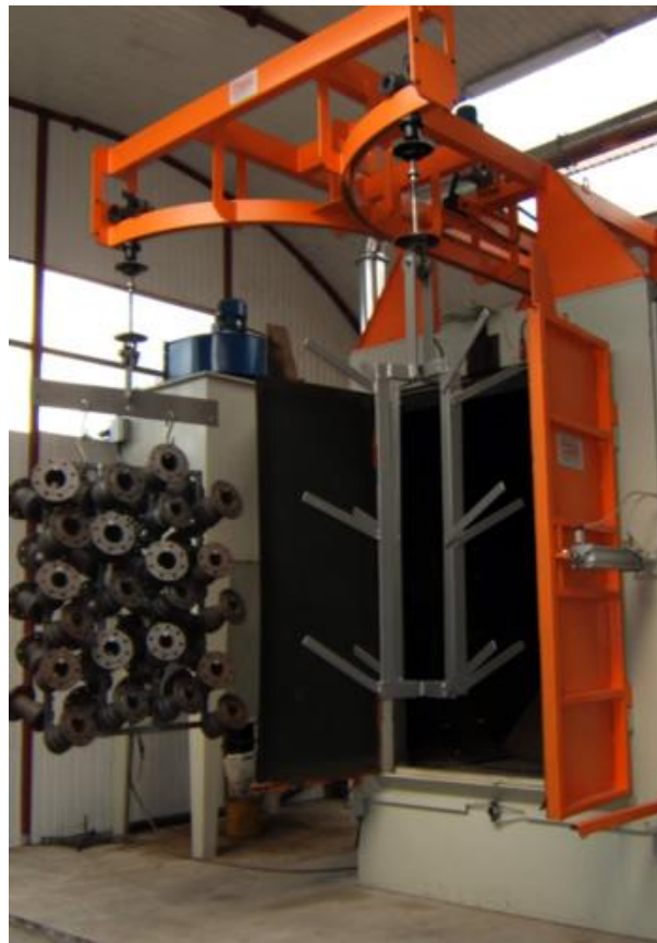
Rys. 4. Zawieszka przeznaczona do oczyszczania odlewów średniej wielkości o kształcie cylindrycznym
