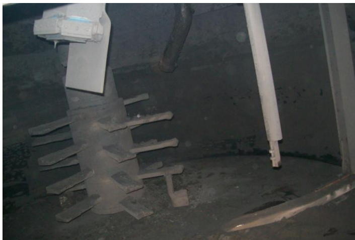
Rys. 4. Sonda pomiarowa wilgotności zamontowana w mieszarce.
