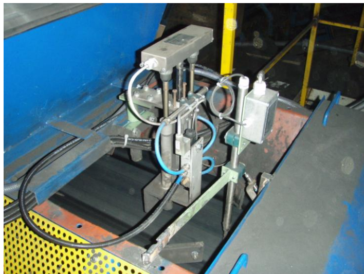
Rys. 2. Pomiar temperatury i wilgotności masy zwrotnej za chłodziarką.
