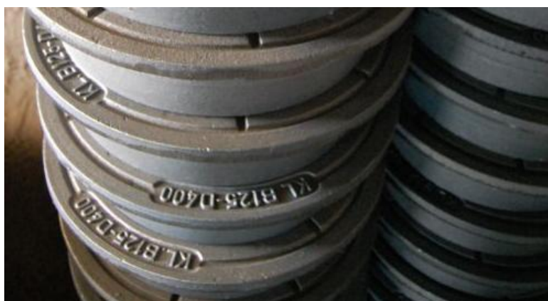
Rys 6. Przykład odlewów włączów kanalizacyjnych.
