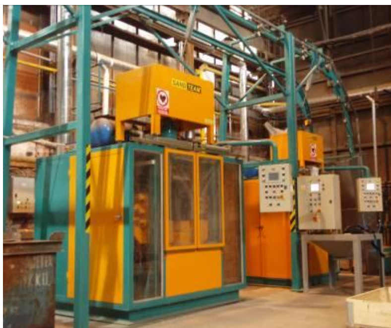
Rys. 2. Strzelarki VGi 20.0 i VGi 12.0. Częścią instalacji jest też automatyczna sekcja przygotowania masy i jej rozwój k poszczególnym maszynom
