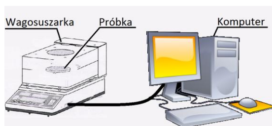
Rys. 1. Stanowisko do badań kinetyki suszenia mas
