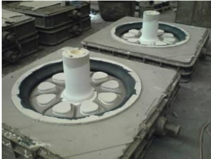
Rys. 6. Forma dla odlew staliwny, wykonana przy pomocy technologii RUDAL.
