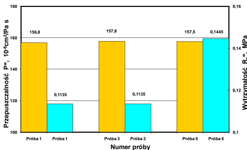
Rys.8. Wartości właściwości technologicznych masy odświeżanej w mieszarce wirnikowej MTP-3000 dla różnych prędkości obrotowych miski dla badań: 33, 35, 37 ( n_m = 6,72 1/min, n_m = 10,08 1/min, n_m = 12,06 1/min)
