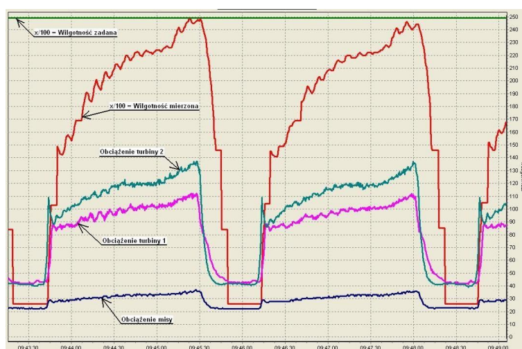
Rys. 9. Wpływ wilgotności i jednorodności masy na obciążenia napędów elementów mieszających w mieszarce.
