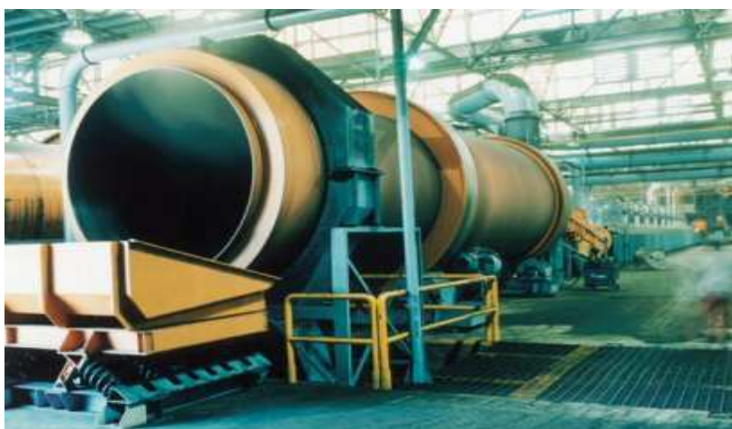
Rys. 4. Widok wieloczynnościowego bębna obrotowego DISACOOOL, firmy DISA [19]
