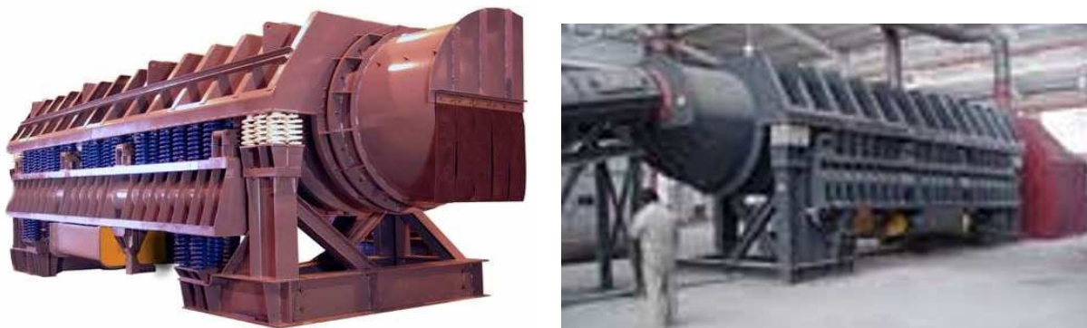
Rys. 10. Widok wieloczynnościowego bębna wibracyjnego VIBRA- DRUM, firmy GENERAL KINEMATICS Corp. [19]
