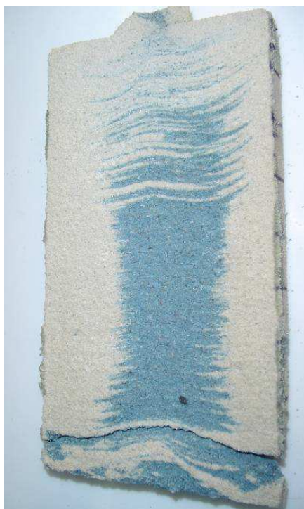
Rys. 7. Wyniki badań ultradźwiękowych: rozkład prędkości fali w na przekroju rdzenia wykonanego jako dwuwarstwowy z masy ze szkłem wodnym, b/ widok rdzenia w przekroju.
