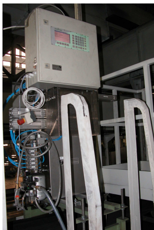
Rys.7. System do automatycznego pomiaru i regulacji wilgotności masy formierskiej MICOMP UNI typ G-FBK w chłodziarce wibrofluidyzacyjnej firmy Michenfelder w Zlieváreň Trnava s.r.o. – Trnava (Słowacja)
