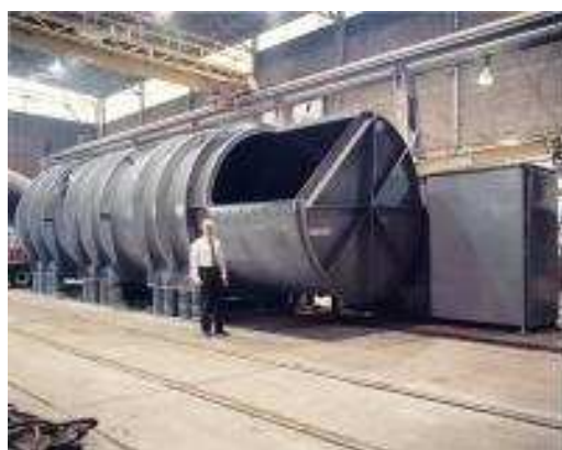
Rys. 9. Widok wieloczynnościowego bębna wibracyjnego Barrel Horse TM , firmy Carrier Vibrating Equipment Inc.[]
