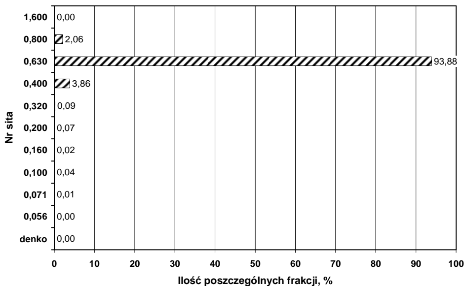
Rys. 5. Ilości frakcji 0,63 mm piasku OK2: a) wyjściowego, b) po 5 cyklach w urządzeniu z pobocznicą uderową, dla prędkości 6500 obr/min.
