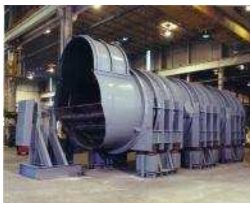
Rys. 9. Widok wieloczynnościowego bębna wibracyjnego Barrel Horse TM , firmy Carrier Vibrating Equipment Inc.[]
