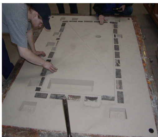
Rys. nr 4 Forma z masy samoutwardzalnej z RUDALEM A niemieckiej odlewni aluminium. Dawkowanie 1,8 – 2,0 % spoiwa.
