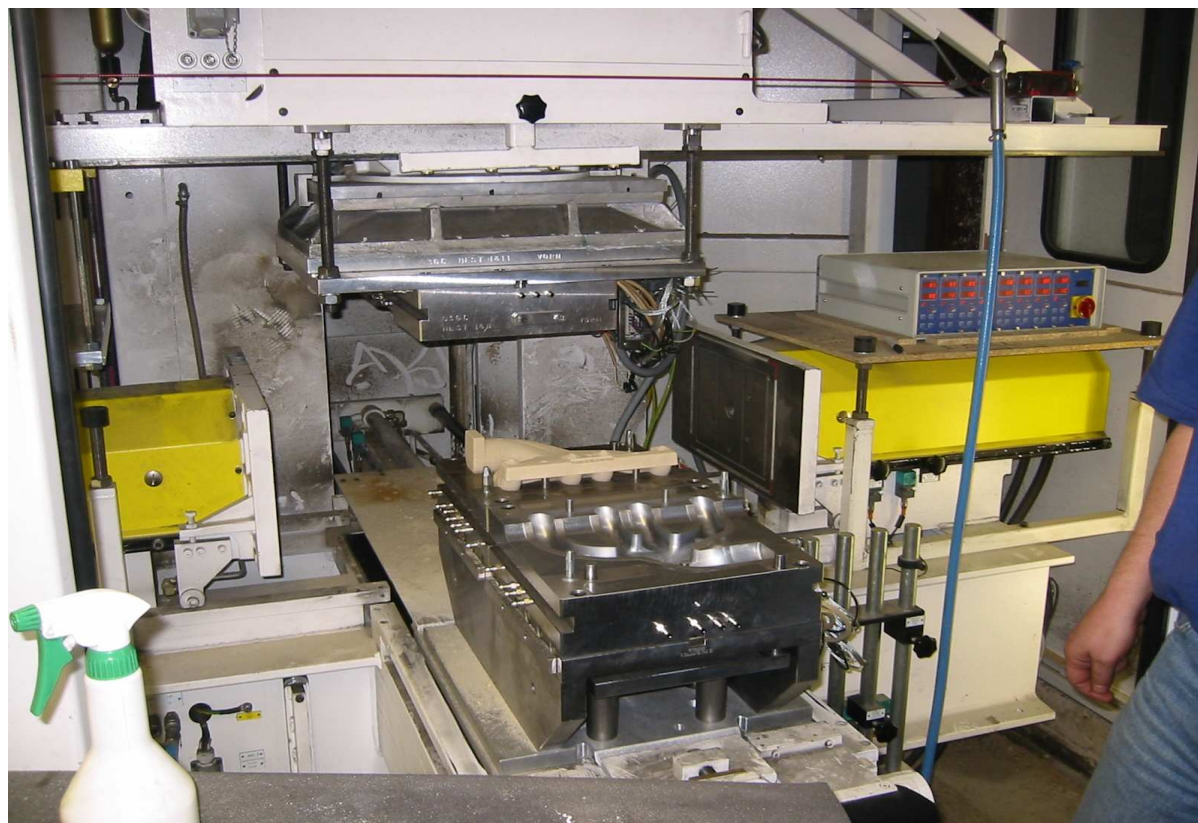
Rys. 9. Stanowisko doświadczalne wykonywania rdzeni w technologii Cordis
