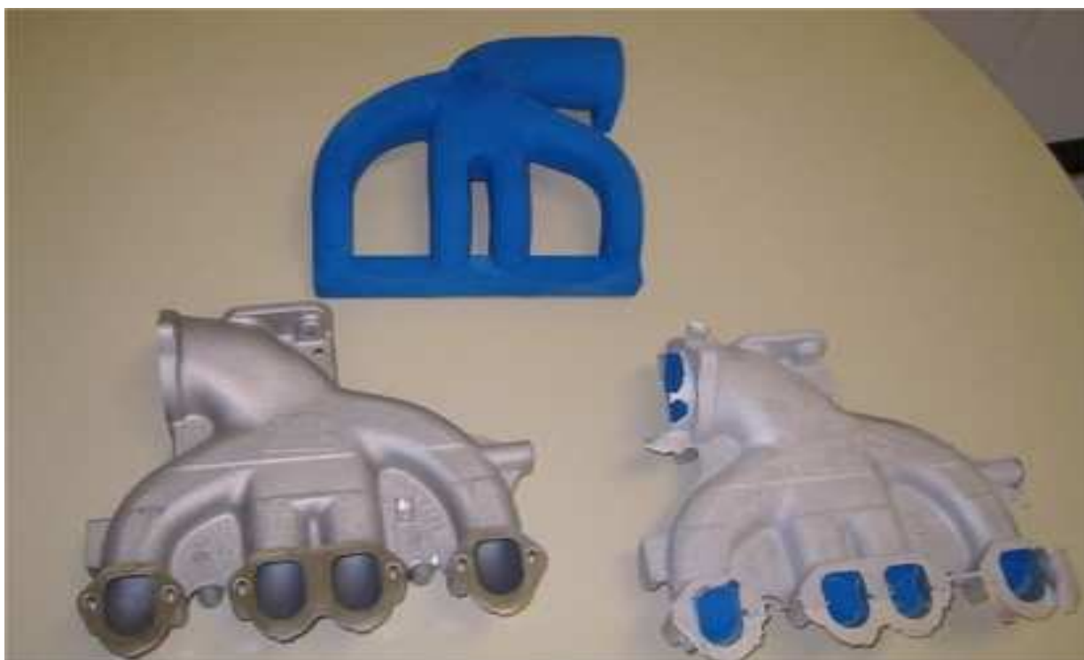
Rys.3 a,b Rdzeń ze spoiwem Cordis, odlew z zastosowaniem rdzenia
