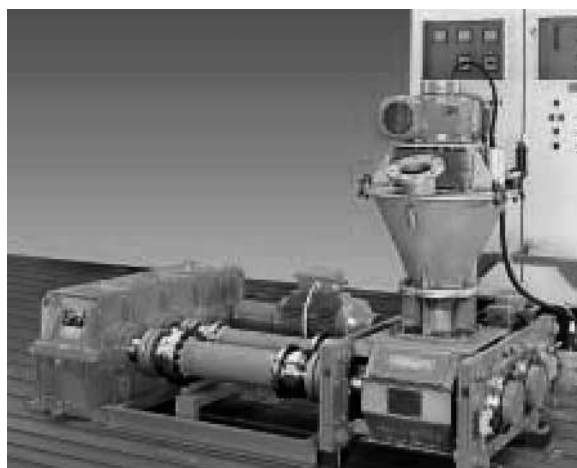
Rys.10a. Schemat procesu brykietowania w prasie walcowej firmy Maschinenfabrik Köppern GmbH & Co. KG [14, 15]
