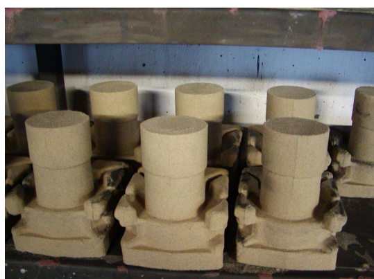
Rys. nr 9 Rdzenie utwardzane CO 2 dla odlewów brązowych. Dawkowanie 2,5 % RUDAL A , 0,6 % GEOTEK 007
