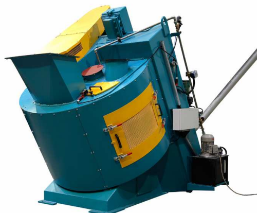
Rys.7. Mieszarka turbinowa MTI-1500 produkcji TECHNICAL Nowa Sól, zamontowaną w odlewni VENTURE INDUSTRIES Grudziądz
