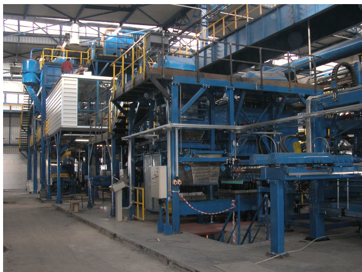
Rys.3. Systemu sporządzania mas formierskich bentonitowych SPM-45w odlewni VENTURE INDUSTRIES Grudziądz
