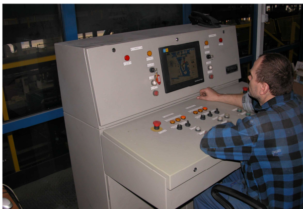
Rys.10. Pulpit sterowniczy SPM-45 oraz ALF-100.80 z systemem wizualizacji
