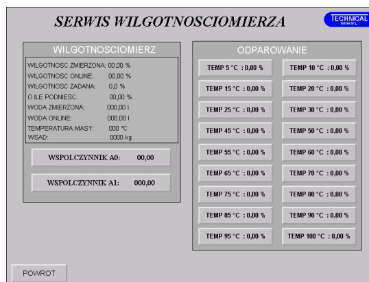
Rys.9. Ekran synoptyczny automatycznego pomiaru i regulacji wilgotności typ RWM-1
