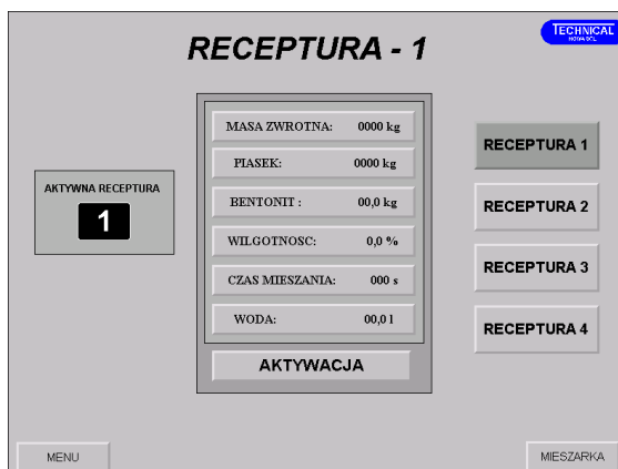
Rys.11. Ekran nastaw technologicznych - receptury masy formierskiej
