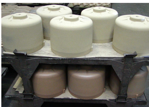
Rys. nr 8 Rdzenie ze spoiwem RUDAL A utwardzone CO 2 w czeskiej odlewni żeliwa szarego. Dawniej stosowano technologię rezol - CO 2
