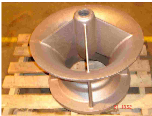
Rys. nr 3 Odlew stalowy wykonany do formy z masy samoutwardzalnej z RUDALEM A w odlewni amerykańskiej. Dawkowanie 1,6 – 2,0 % spoiwa, 50 % regeneratu. Czas rozbierania 20 min.
