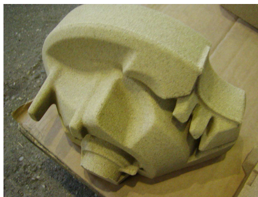
Rys. nr 7 Rdzeń utwardzony CO 2 ze spoiwem RUDAL A dla odlewu aluminiowego w słowackiej odlewni aluminium
