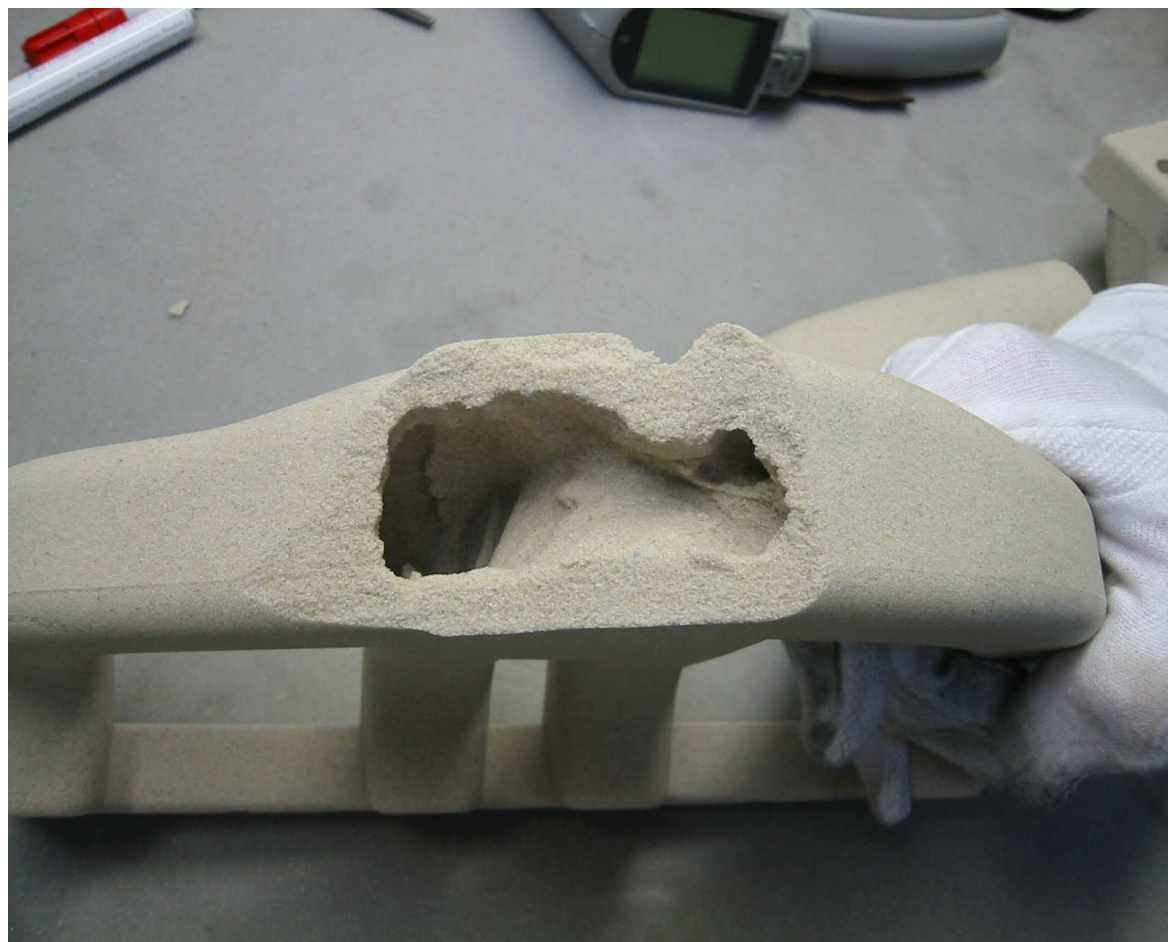
Rys 2 Tworzenie się skorupy na rdzeniu rury ssącej ze spoiwem Cordis, bezpośrednio po wyjęciu z maszyny.
