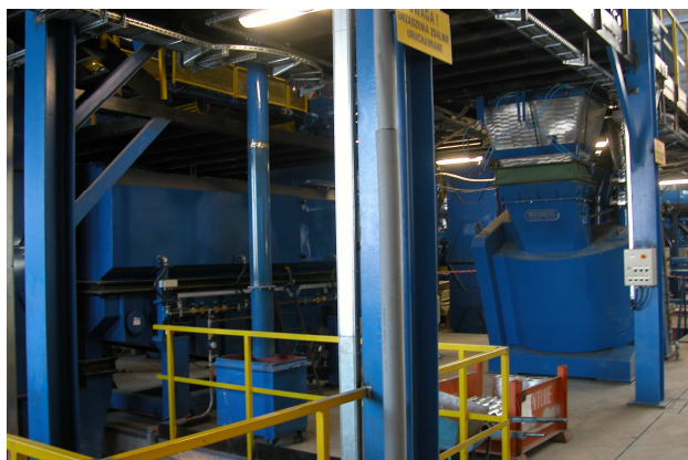
Rys.8. Zabudowa chłodziarki wibrofluidyzacyjnej CFM-3510
