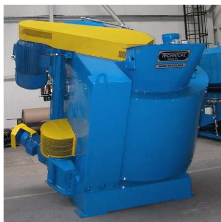
Rys.11. Mieszarka turbinowa z obrotową misą o pochylej osi obrotu typu MTP.
