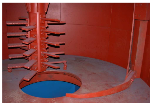
Rys.2. Szybkobieżna turbina i nieruchome lemieszki w mieszarce turbinowej MTP-1500.
