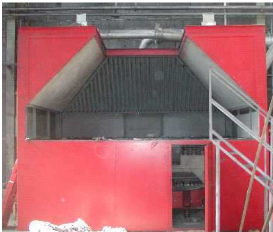
Rys. 9. Stosowana w eksploatacji regeneracja masy zwrotnej ze spoiwem geopolimerowym przez ścieranie mechaniczne (Omega, GB).
