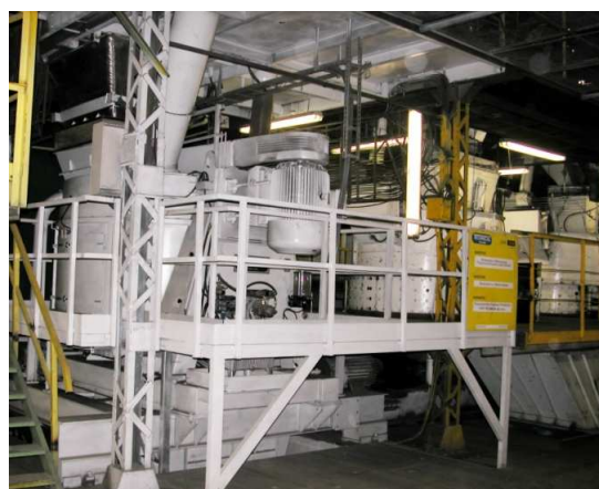
Rys.15. Zabudowa mieszarki turbinowej MTI-2500 w odlewni ŠKODA – Mlada Boleslaw (Czechy):
