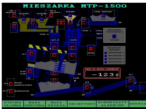
Rys.18. Ekran synoptyczny mieszarki turbinowej MTP-1500 w odlewni WSK PZL RZESZÓW.
