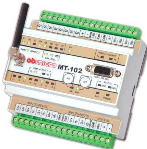
Rys. 5. Moduł MT-102 umożliwiający komunikację za pomocą pakietowej transmisji danych GPRS.
