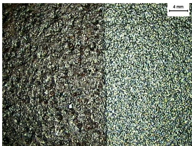
Rys. 17. Powierzchnia wyjściowa – a), oczyszczona – b); parametry oczyszczania: prędkość obrotowa wirnika rzutowego 2900 obr/min, czas oczyszczania 60 s, liczba wirników oczyszczających 1-górny; powiększenie 3x - mikroskop Leica MZ6
