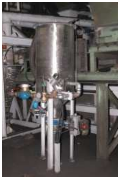
Rys.5. Instalacja dozowania wody do mieszarki MTI-2500 zamontowana w odlewni ŠKODA – Mlada Boleslav (Czechy).
