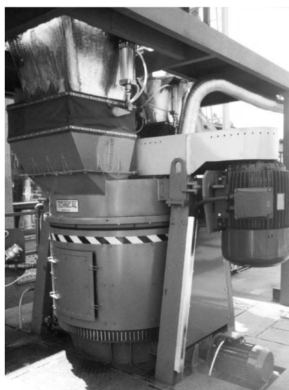
Rys. 5. Układ dozowania składników do mieszarki MTI
