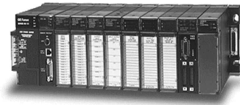
Rys. 1.1 Przykładowy sterownik GE Fanuc serii 90-30 zmontowany na płycie łączeniowej z zasilaczem, modułem jednostki centralnej i pozostałymi modułami
